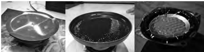
Figura 5. Registro fotográfico de patrones cimáticos obtenidos en la experimentación, de izquierda a derecha: sal sobre placa metálica, agua con tinta en recipiente, fluido no newtoniano sobre altavoz. Sergio Benejam 2019.
