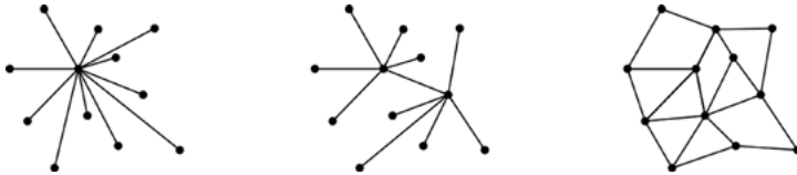
Figura 3. Esquemas de las estructuras de red de Baran: centralizada, descentralizada, distribuida. Peries, 2018.
